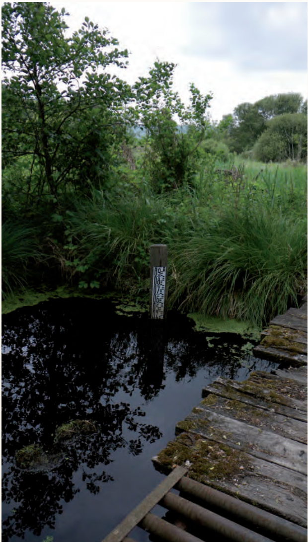
Suivi des niveaux de l'eau à l'aide d'une échelle - PNRBSN / F. Rosanska
