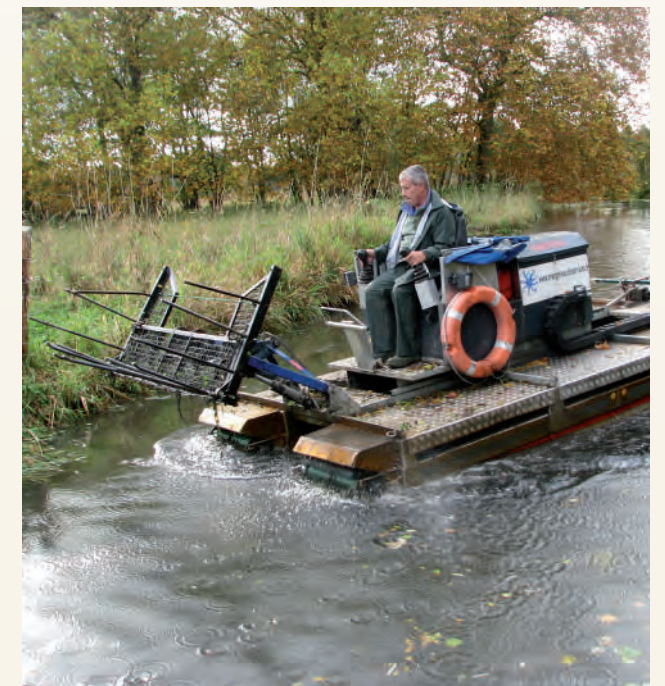
Engin motorisé pour travaux de fauche, faucardage, ramassage, etc. en milieu aquatique - A. Watterlot
